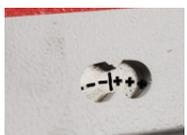
Indikator der Sägebandspannung
