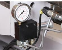
Spanndruckregelung des Spannstocks
