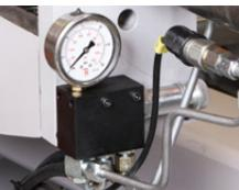
Spanndruckregelung des Spannstocks
