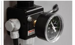
Anzeige und Regulierung des Eingangsdruck mit Filter
