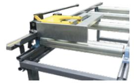
XA manueller Materialanschlag. Die Längeneinstellung und Supportfixierung sind manuell. Die Länge wird von der Zonenskala mithilfe der eingebauten Luppe abgelesen. Der Anschlag kann manuell für zügige Materialabfuhr nach oben geklappt werden.
