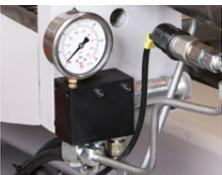
Spanndruckregelung des Spannstocks
