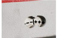
Indikator der Sägebandspannung
