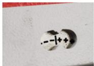
Indikator der Sägebandspannung
