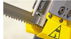
Sägebandführung aus Hartmetall
