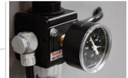
Anzeige und Regulierung des Eingangsdruck mit Filter
