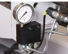
Spanndruckregelung des Spannstocks
