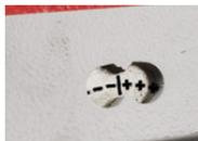
Indikator der Sägebandspannung
