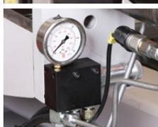
**Spanndruckregelung des Spannstocks**
