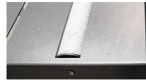
Steife Kunststoffrollen gewährleisten stufenlose Materialbewegung und zugleich Schutz vor dessen Beschädigung
