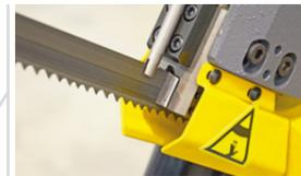
Sägebandführung aus Hartmetall
