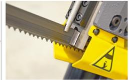
Sägebandführung aus Hartmetall
