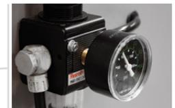
Anzeige und Regulierung des Eingangsdruck mit Filter
