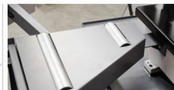
Jeder Bandsäge steht ein angepasstes Anschlussstück, einschl. der Verbindungselemente zur Verfügung. Die Rollenbahn System M ist vorrangig für Modelle der Sägen Ergonomic, Aluminium und Practix ausgelegt.
