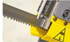
Sägebandführung aus Hartmetall
