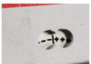
Indikator der Sägebandspannung
