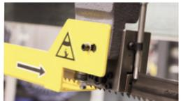
Sägebandführung aus Hartmetall
