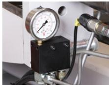
Spanndruckregelung des Spannstocks
