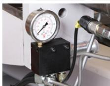
Spanndruckregelung des Spannstocks
