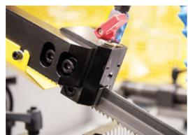
Sägebandführung aus Hartmetall
