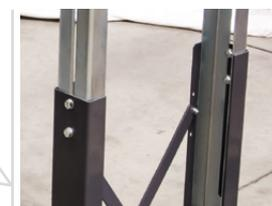
Die Stützfüße der Rollenbahnen M sind mit einem verstellbaren Teil versehen, mit dem einfach die erwünschte Höhe der Rollenbahn angepasst werden kann
