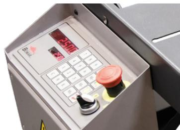
Das System MNCA ist ein durchaus günstiges und komfortables Längenmesssystem. Die speziell entwickelte Steuerung ermöglicht, bis zu 99 unterschiedliche Längen zu speichern, die anschließend mit einer Tastenbetätigung vom Speicher abgerufen werden können.
