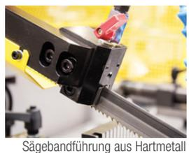
Sägebandführung aus Hartmetall
