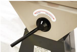
Dank dem einfachen Hebelsystem kann die Maschine in die gewünschte Position eingestellt werden
