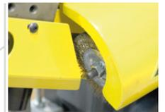
Bürste zur Reinigung des Sägebands
