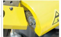
Bürste zur Reinigung des Sägebands
