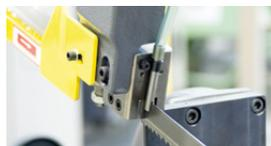
Sägebandführung aus Hartmetall
