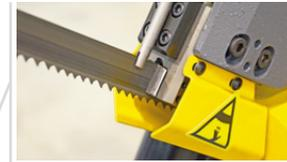
Sägebandführung aus Hartmetall
