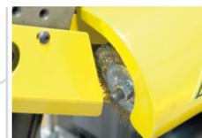
Bürste zur Reinigung des Sägebands
