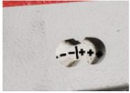
Indikator der Sägebandspannung
