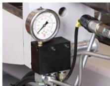
Spanndruckregelung des Spannstocks
