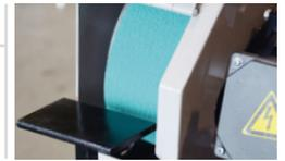
Die Späneabfuhr dient zugleich als Aufsatz für die Absaugeinrichtung
