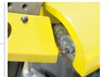
Bürste zur Reinigung des Sägebands
