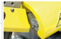
Bürste zur Reinigung des Sägebands
