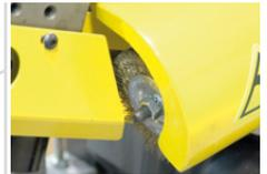
Bürste zur Reinigung des Sägebands
