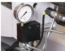
Spanndruckregelung des Spannstocks
