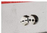
Indikator der Sägebandspannung
