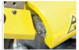
Bürste zur Reinigung des Sägebands
