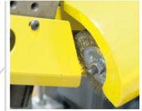
Bürste zur Reinigung des Sägebands
