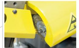
Bürste zur Reinigung des Sägebands
