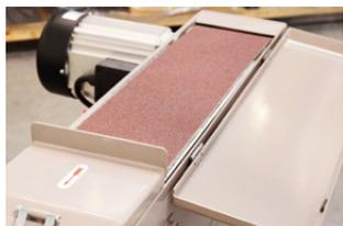
Die obere Maschinenabdeckung kann geöffnet werden, was die Bildung einer weiteren Schleiffläche und Kontrolle des Schleifbands ermöglicht
