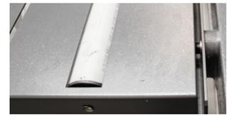
Steife Kunststoffrollen gewährleisten stufenlose Materialbewegung und zugleich Schutz vor dessen Beschädigung
