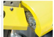
Bürste zur Reinigung des Sägebands
