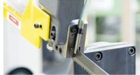
Sägebandführung aus Hartmetall
