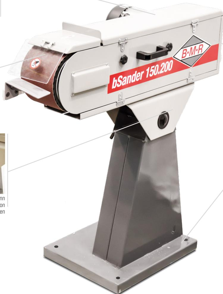
Die Späneabfuhr dient zugleich als Aufsatz für die Absaugeinrichtung
