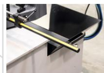
Möglicher Anschluss des Längenaufschlags
