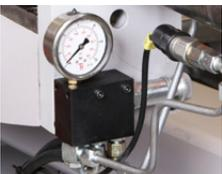
Spanndruckregelung des Spannstocks
