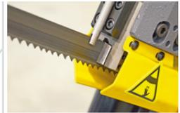
Sägebandführung aus Hartmetall
