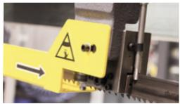
Sägebandführung aus Hartmetall
