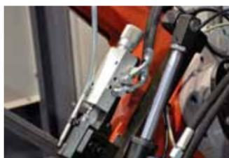
Die Vorschubgeschwindigkeit wird auf der Bedientafel separat eingestellt. Der Schneiddruck wird am Führungsstück eingestellt.
