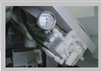
Hydraulische Sägebandspannung mit
