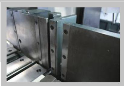
Doppelspannsystem für kurze Reststücke und gratarme Schnitte
