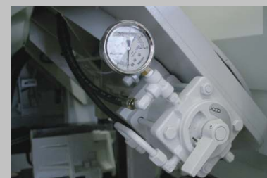
Hydraulische Sägebandspannung mit automatischer Entlastung bei Maschinen- stillstand zur Schonung des Sägebandes
