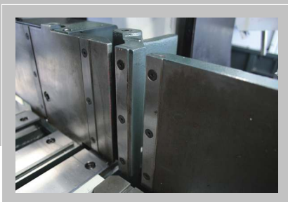
Doppelspannsystem für kurze Reststücke und gratarme Schnitte
