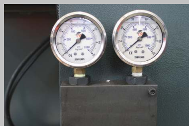
Spanndruckregulierung zum Spannen dünnwandiger Rohre und Profile
