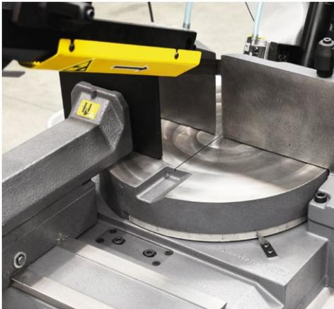
Synchron drehbarer Tisch des Hauptspannstockes.
