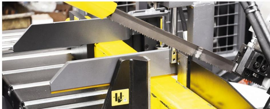
Durchgehende Rollenbahn in der ganzen Länge der Bandsäge.
