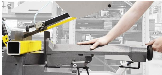
Dank dem einstellbaren Führungsrahmen ist die Sägebandführung immer möglichst nah dem Material situiert.
