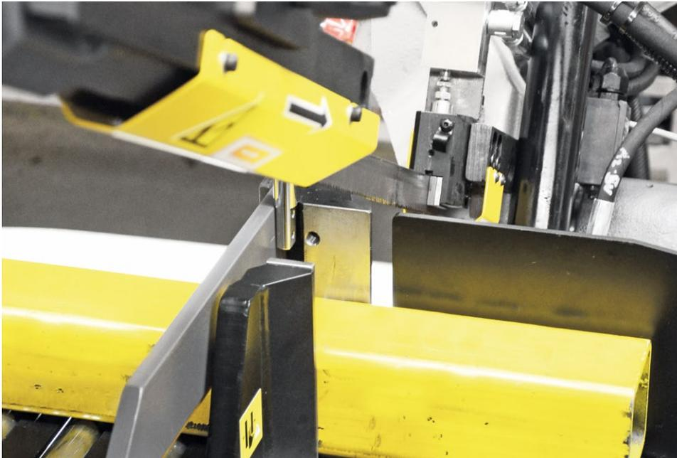
Der Hauptspannstock ist so konzipiert, dass auch bei den Gehrungsschnitten, die in der automatischen Betriebsart bis zu 45° manuell einstellbar sind, eine extrem kurze Länge der Reststücke von 20 mm erreicht wird.
