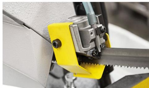
Die hochpräzisen, geschliffene Hartmetall-Seitenführungen sorgen für stetige Schnittgenauigkeit.
