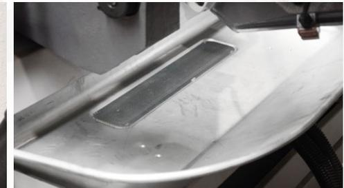
Große, einfach zugängliche Spänenwanne mit Abtropfsieb verhindert Entweichen der Kühlflüssigkeit außer der Anlage.
