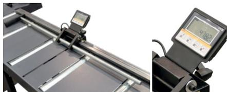
Die Längenanzeige befindet sich direkt am Support des Anschlags und zeigt die genaue Position in Echtzeit an. Das Anzeigesystem bietet verschiedene Möglichkeiten der Einstellung und Prozessoptimierung an
