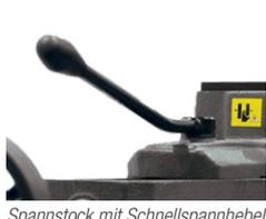
Spannstock mit Schnellspannhebel
