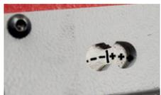
Indikator der Sägebandspannung
