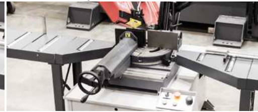
Detail der Anschließung des rechten sowie linken Förderbands
