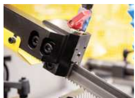
Sägebandführung aus Hartmetall
