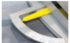
Übersichtliche, auf der Vorderseite der Maschine angebrachte Winkelskala
