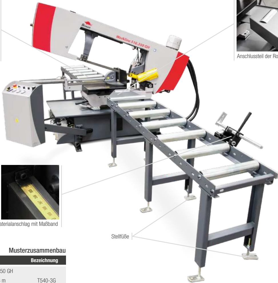
Das System T ist mit Rollen mit einem Durchmesser von 70 mm versehen und bewältigt somit auch hohe Belastung
