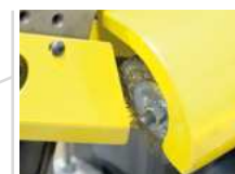
Bürste zur Reinigung des Sägebands
