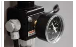
Anzeige und Regulierung des Eingangsdruck mit Filter
