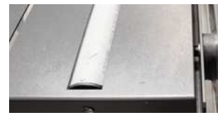
Steife Kunststoffrollen gewährleisten stufenlose Materialbewegung und zugleich Schutz vor dessen Beschädigung
