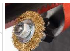
Reinigungsbürste des Sägebands
