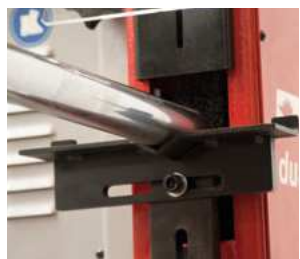
Die verstellbare Abdeckung des Eingangsbereichs der Maschine bietet maximale Arbeitsstabilität
