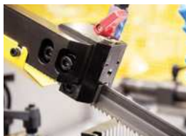
Sägebandführung aus Hartmetall
