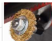
Reinigungsbürste des Sägebands
