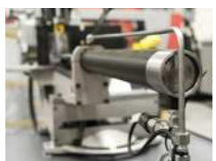
Vollhubzylinder des Spannstocks
