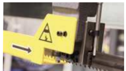
Sägebandführung aus Hartmetall
