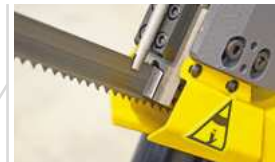
Sägebandführung aus Hartmetall
