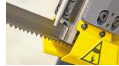
Sägebandführung aus Hartmetall
