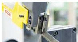
Sägebandführung aus Hartmetall
