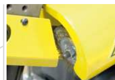
Bürste zur Reinigung des Sägebands
