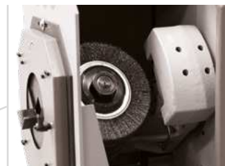
Zugang zur Scheibenbürste zu Servicezwecken
