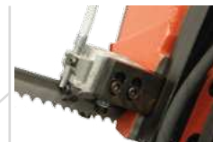
Sägebandführung aus Hartmetall
