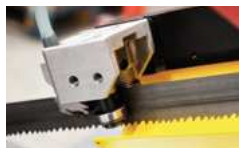
Sägebandführung aus Hartmetall
