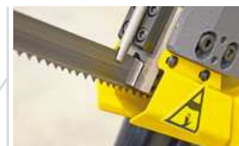
Sägebandführung aus Hartmetall
