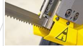
Sägebandführung aus Hartmetall
