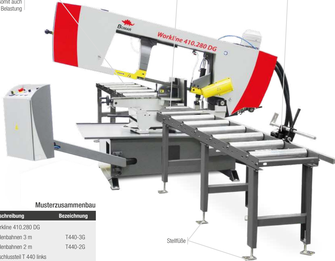
TA - Manueller Materialansschlag mit Maßband
