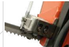
Sägebandführung aus Hartmetall
