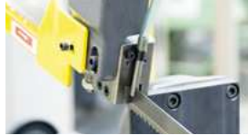
Sägebandführung aus Hartmetall
