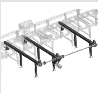
Querfördereinheit mit vorderer Auslegung, Antriebseinheit des Quervorschubs und eigener hydraulischer Hubeinheit.
