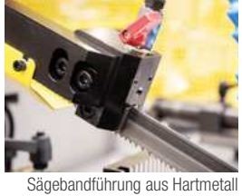
Sägebandleitung aus Hartmetall
