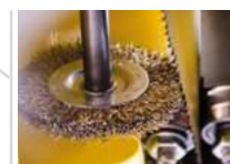
Reinigungsbürste des Sägebands
