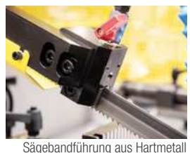
Sägebandführung aus Hartmetall
