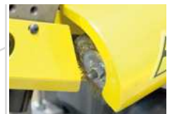
Bürste zur Reinigung des Sägebands
