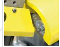
Bürste zur Reinigung des Sägebands
