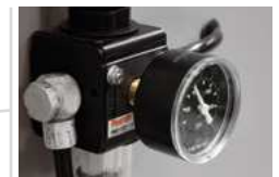
Anzeige und Regulierung des Eingangsdruck mit Filter
