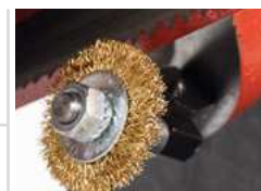
Reinigungsbürste des Sägebands
