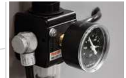
Anzeige und Regulierung des Eingangsdruck mit Filter
