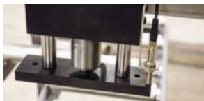
Fester vertikaler Spannstock für bessere Stabilität des Materials
