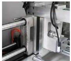
Robuster Vorschubspannstock für genauen Materialvorschub
