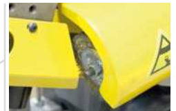
Bürste zur Reinigung des Sägebands
