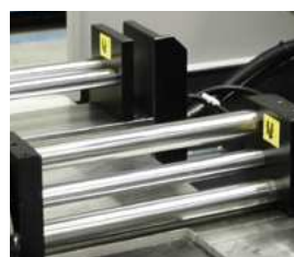
Die Maschine ist mit zwei hydraulischen Spannstöcken versehen
