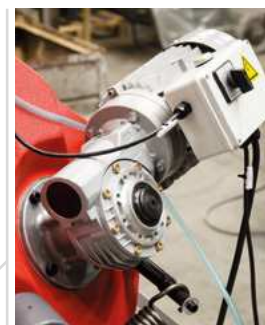
Schneckengetriebe mit Motor für industriellen Einsatz
