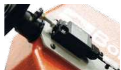
Sägebandführung aus Hartmetall
