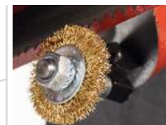
Reinigungsbürste des Sägebands
