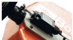
Sägebandführung aus Hartmetall
