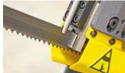
Sägebandführung aus Hartmetall
